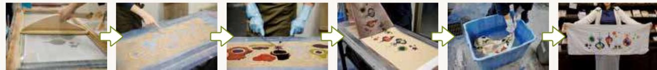
将固定在木框上的纸版放在布上，然后用刮刀涂抹胶水
