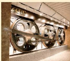
丸の内地下南口改札外にある蒸気機関車の動輪のある広場。かつて東海道線を走っていたC62-15型蒸気機関車のもので、直径1.75mの動輪が3つ並んでいます。
