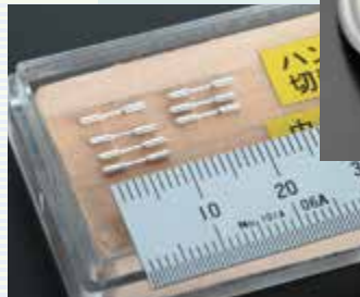
難しい加工の微細なはんだ試験片 (インパクト)
