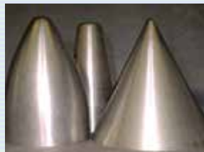
絞りの技術で職人達が手作業で成形した ロケットの先端 (北嶋紋製作所)
